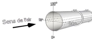
La technologie de pulsion tangentielle ou coaxiale utilisée par PULSAIR consiste à utiliser l'air de soufflage afin de mettre en mouvement à basse vitesse, de façon contrôlée et déterminée, la totalité de la masse d'air d'un volume.
